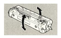
4. カートリッジの左右の突起を本体内部のがイドに合わせて押し込みます。
