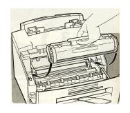
5. 奥に突き当たったらカートリッシでのハント・ルを奥に倒すように強く押し、カチッとロックされることを確認します。
